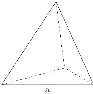
Es handelt sich um einen regulären Tetraeder. Alle Kanten sind gleich lang mit  $a=8$  mm. Die Oberfläche beträgt:  $A = a^2 \cdot \sqrt{3}=110$   $\text{mm}^2$ .
