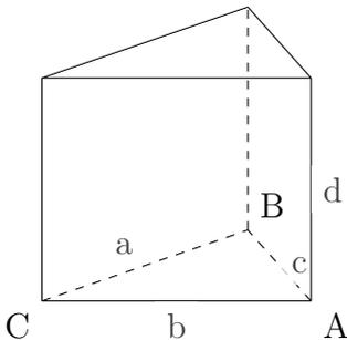
Es handelt sich um ein Prisma. Die Grundfläche wird durch ein Dreieck ABC mit einer Fläche von  $A(\text{Dreieck}) = 54 \text{ m}^2$  gebildet. Es gilt  $a = 9 \text{ m}$ ,  $b = 12 \text{ m}$ ,  $c = 15 \text{ m}$ ,  $d = 10 \text{ m}$ . Die Oberfläche beträgt:
